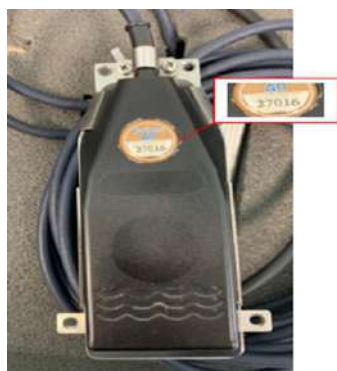
Рисунок 11 - Погружной датчик Доплера ДП с компенсатором барометрического давления серийный № 27016
