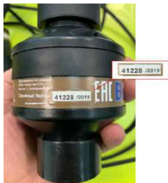
Рисунок 9 – Ультразвуковой датчик уровня ДУ-3 серийный № 41228
