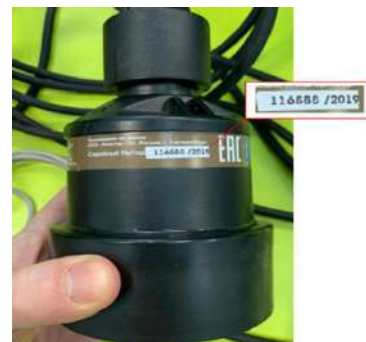
Рисунок 10 - Радарный датчик скорости ДС-6 серийный № 116888
